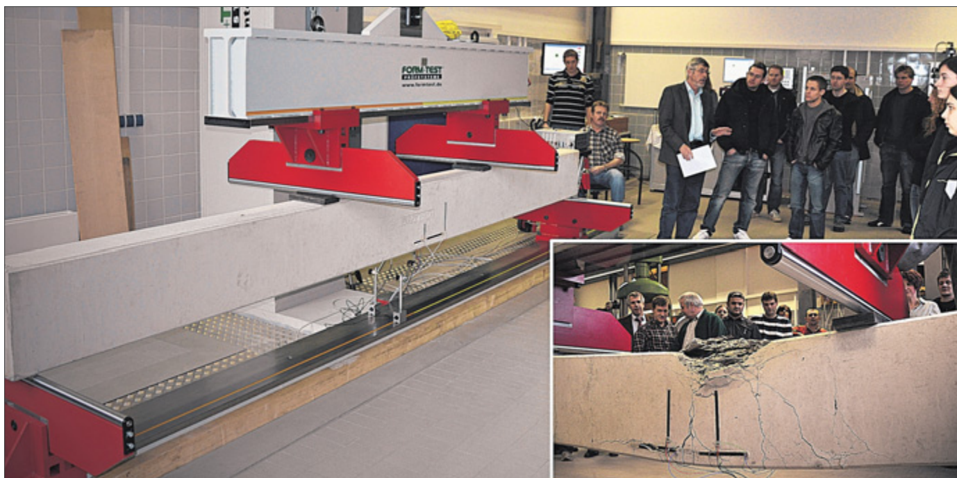
Die neue Universalprüfmaschine des Instituts für Konstruktiven Ingenieurbau in Aktion: der Stahlbetonbalken wird belastet, bis er bricht.
