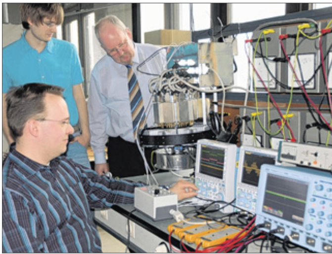
Die Messungen am Matrix-Umrichter beobachten Professor Dr. Günter Schröder, der Student Christian Bender und Markus Pfeifer.
